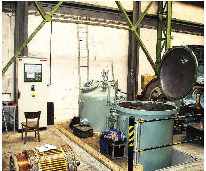
Vakuotlaková impregnace trakčních motorů
