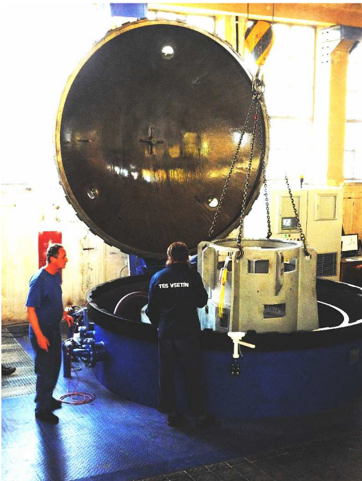
Vakuotlaková impregnace generátoru
